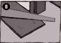
Feste Bauteile wie Türzargen müssen gekürzt werden, damit das **MORENA-FERTIGPARKETT** darunter liegen kann. Es darf nicht anstoßen. Vor der Kürzung der Türzarge muß geprüft werden, dass die Türzarge dauerhaft befestigt ist. Ein Absacken der Türzarge könnte die Bewegungsfreiheit des **MORENA-FERTIGPARKETT** beeinträchtigen.
