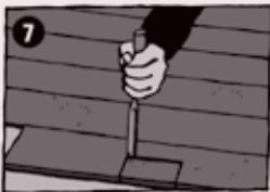
Ausklinkungen können mittels Säge und Stecheisen vorgenommen werden.
