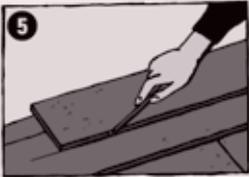
Die letzte Dielenreihe wird in die richtige Breite gesägt. Dabei ist auf die Dehnungsfuge zu achten! Danach wird die Dehnungsfuge mit einer Fußleiste abgedeckt. Sie darf allerdings nicht zu dicht auf dem **MORENA-FERTIGPARKETT** liegen, um die Bewegungsfreiheit des Bodens nicht zu beeinträchtigen.
