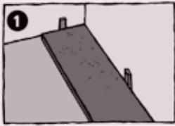
Eine Dehnfuge von mind. 10 mm zwischen dem **MORENA-FERTIGPARKETT** und der Wand sowie allen festen Bauteilen wie Heizungsrohre, Türzargen usw., muss eingehalten werden. Bei großen Räumen (ab 8 m Breite) muss die Dehnfuge mind. 1,5 mm pro Meter max. Raumbreite betragen (z. B. 10 m max. Raumbreite = 15 mm Dehnfuge). Die Bodenfläche von 80 m<sup>2</sup> in einer Fläche sollte nicht überschritten werden.
