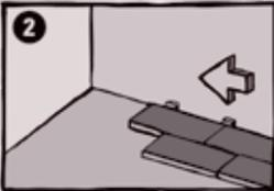
Es ist zu empfehlen an einer geraden Wand längs zum Lichteinfall von links nach rechts zu beginnen. Bei den Dielen der ersten Reihe wird die Feder der Langkante mit einer geeigneten Säge abgeschnitten, so dass die Schnittkante zur Wand zeigt. Die folgenden Dielenreihen sollen mind. 1/3 versetzt verlegt werden. Optimal ist die Verlegung im Halbverband.
