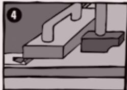
Zum Zusammenfügen der Kurzkante schlagen Sie diese mit der KWG „uniclic“ Schlagleiste (Art.-Nr.: 0285) vorsichtig ineinander. Bei zu starkem Zusammenklopfen kann sich die Korkauflage im Kantenbereich hochdrücken. Für die letzte Diele in einer Reihe benötigen Sie ein Zugeisen zum Zusammenfügen.
