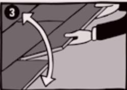
**MORENA-FERTIGPARKETT** wird üblicherweise nicht geleimt, sondern trocken verlegt. Dabei werden die einzelnen Dielen mit der Feder der Langkante in die Nut der davor liegenden Diele in einem Winkel von 20-30° eingedreht, indem man die Diele auf und ab bewegt.
